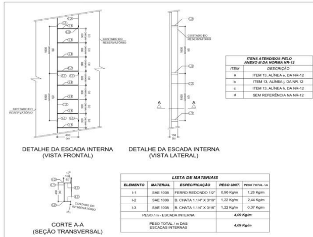
DETALHE DA ESCADA INTERNA PADRÃO NR-12 ESCALA 1:20
