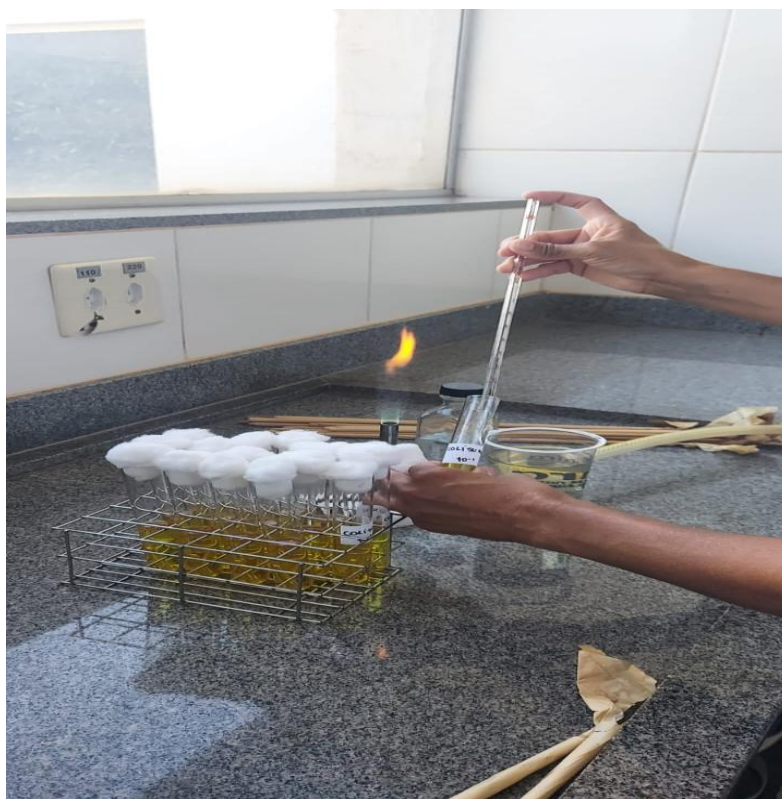
Foto 2: Preparo dos tubos com COLISURE
