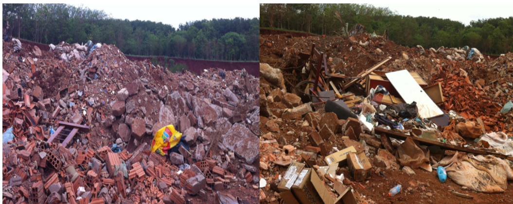
Figura 19: Resíduos da construção civil sem triagem
