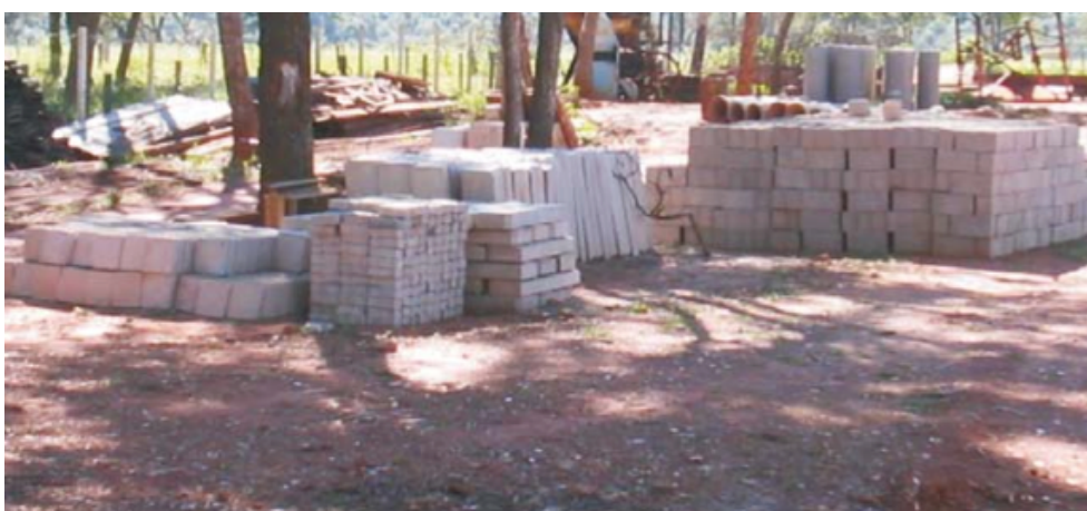
Figura 38: Blocos com agregados reciclados
