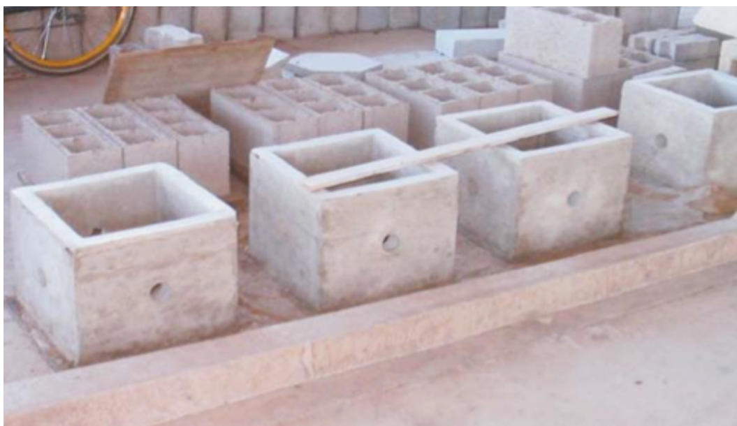
Figura 35: Caixas de Gordura com agregados reciclados
