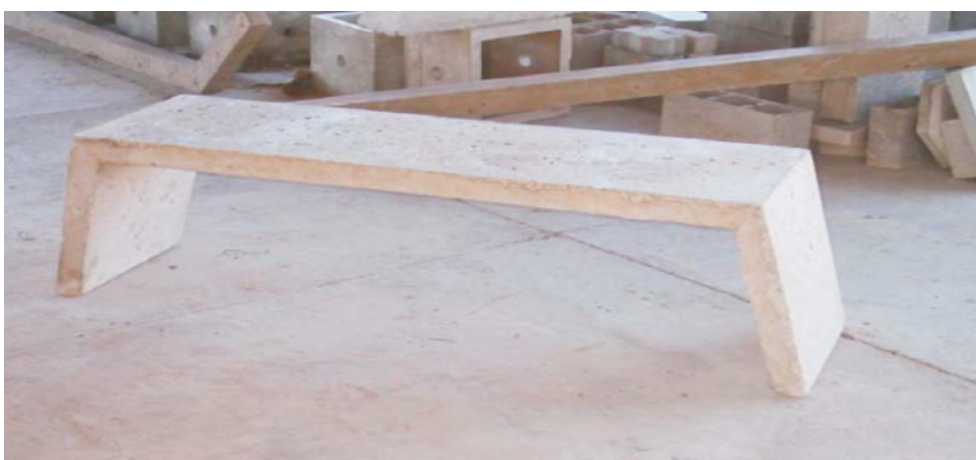
Figura 38: Blocos com agregados reciclados
