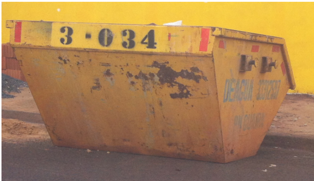
Figura 5: Caçamba estacionária do DEAGUA sendo utilizada, de forma adequada, para o acúmulo dos rcc antes que ocorra o transporte.
